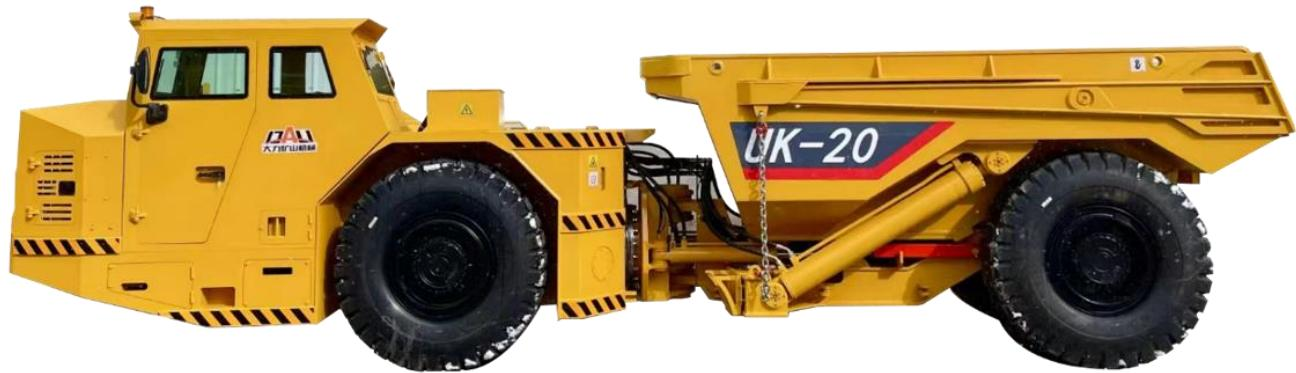
El UK-20 es un Dumper subterráneo con una carga útil de 20 toneladas para una mina de mediana escala. La mejor relación entre carga útil y peso propio de su clase. Está lleno de características para ayudar a las minas a maximizar las toneladas y minimizar los costos.
